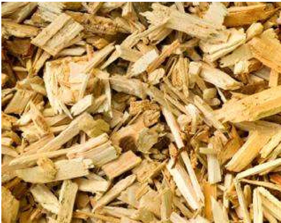
Les copeaux de bois est la matière première du bois, fragmentée en utilisant déchiqueteuses. Une autre utilisation de copeaux de bois en Pologne est la production de panneaux de particules et de la cellulose. Pour produire des copeaux de bois on utilise la matière première de bois avec des défauts
